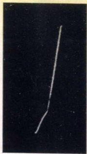
d) Traccie dovute alla disintegrazione di un atomo di azoto bombardato con neutroni. La traccia lunga è della particella \alpha espulsa, quella corta del boro a peso 11 formatosi (N. FEATHER).
