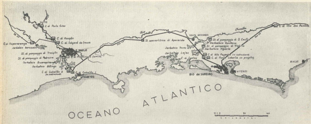
Fig. 7 - Il sistema elettrico della « Rio Light Co. » e della « São Paulo Light Co. »
