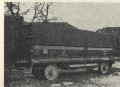
Fig. 10 - Vagone strada-rotaia Verdingen su rotaia.
