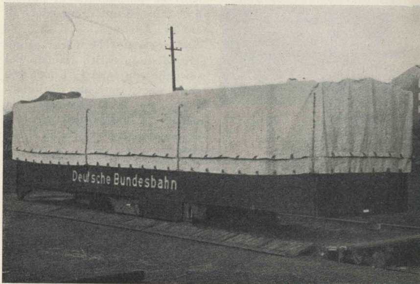
Fig. 16 - Semi-rimorchio « Huckepack » lungo m 10, della portata di 17 tonn. posato su carro per trasporto su rotaia.
