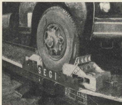
Dispositivo di fissaggio del pneumatico di un camion al carro ferroviario.
