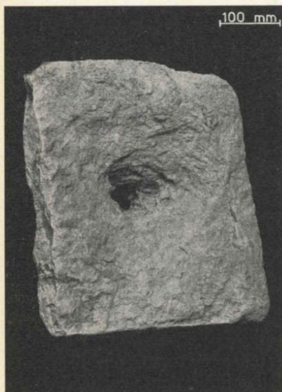
Fig. 6 - Risultato di una prova di perforazione a getto su limo compatto.
