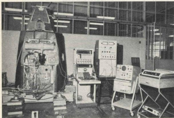
Fig. 11 - G 91 Y: installazione di prova del servocomando equilibratore e dello smorzatore di beccheggio.
