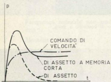
Fig. 4b - Confronto delle risposte indicali in velocità angolare di tre tipi di sistemi di comando.
