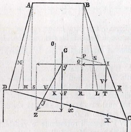
Il peso  $P$ , omessa l'area  $DEC$  trascurabile a fronte dell'area intiera della sezione, sarà espresso da
