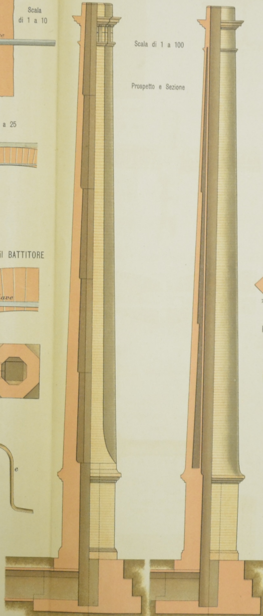
Camino industriale a sezione circolare con parete vuota - o parete doppia con tramezzi di unione radiali
