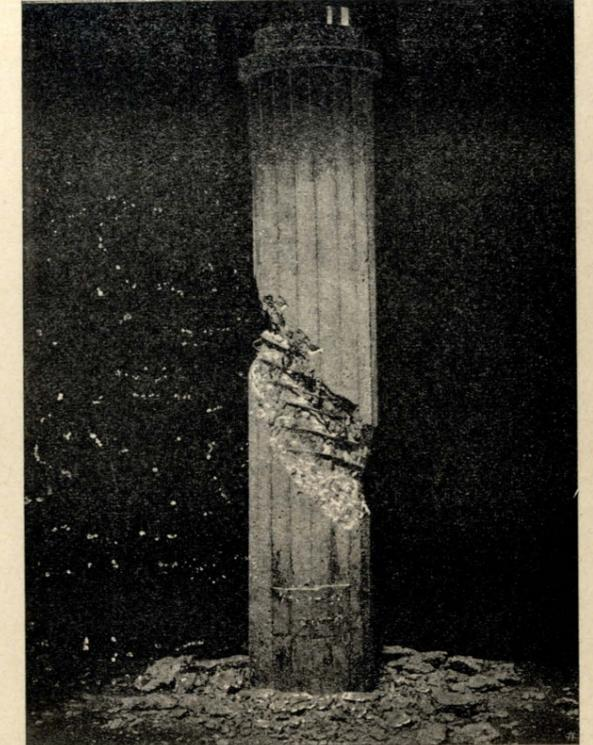
Fig. 4. — Colonnina di béton fretté a schiacciamento molto avanzato.
