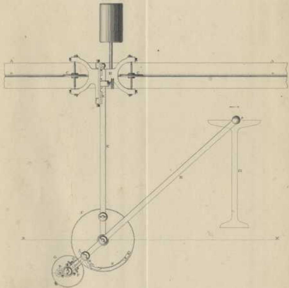
Fig. 2. Disposizione dell' Integratore per la valutazione del momento statico dell'area  $\Omega$  rispetto all'asse XX.
