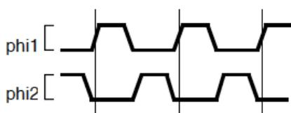
Il processore deve iniziare l'esecuzione di una nuova istruzione ad ogni colpo di clock (a parte le "Ld", le "St" e i salti che richiedendo due cicli di fetch necessitano ovviamente di due colpi di clock per completare la fase di fetch).
