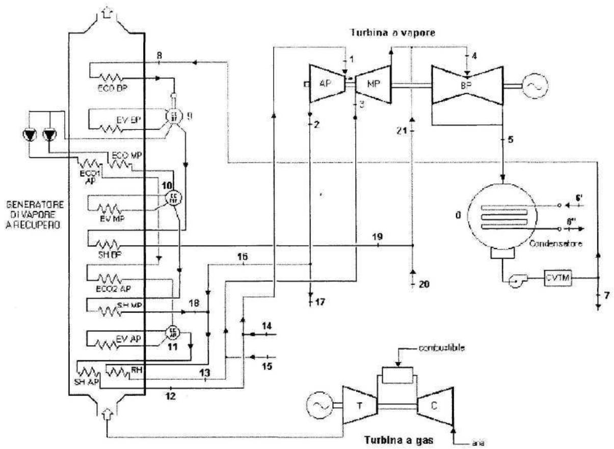
Fig. 2 Schema del generatore di Vapore a recupero
