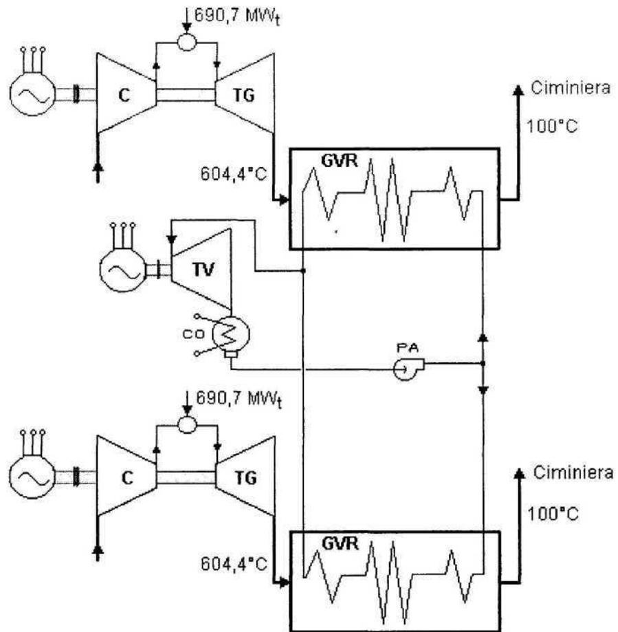
Fig. 1 Schema dell'impianto a ciclo combinato
