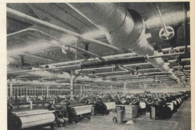
Fig. 3 - Sala di tessitura. File continue di riflettori con lampade fluorescenti TL da 40 Watt. - Illuminazione generale 400 Lux.
