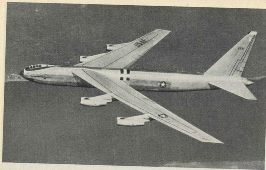
Boeing RB 52-A - Bombardiere a 8 reattori - Q=180 000 kg - S=419 m<sup>2</sup> - Potenza equivalente 129 000 cv. - Peso totale 180 000 kg; Superficie alare 419 m<sup>2</sup>; Carico alare 430 kg/m<sup>2</sup>; Carico per cavallo 1,40 kg/cv; Potenza « equivalente » installata 129 000 cv; Velocità massima 965 km/h; Autonomia 6 500 km; Quota massima 15 000 m.
