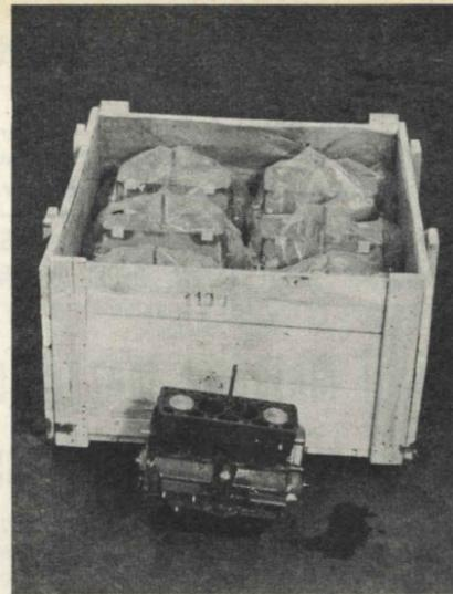
terie, valvole) per i quali si richiede un composto protettivo consistente che dia garanzia assoluta contro la corrosione. La rimozione del protettivo si identifica in ogni caso colla pulitura, sempre prevista per questi pezzi prima della ripresa del montaggio;
