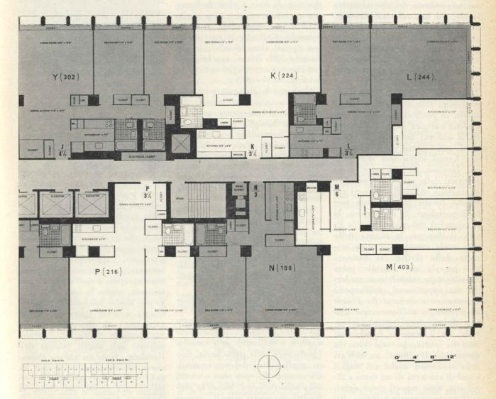
Fig. D-2 - Planimetria generale (in basso, con indicate le lettere corrispondenti ai vari tipi di alloggio) e Pianta di ¼ del monoblocco (con riportate le lettere corrispondenti alla planimetria e a fianco, tra parentesi, l'ammontare dell'affitto mensile in dollari).
