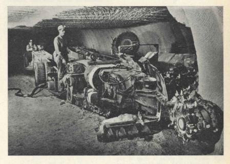
Fig. 6 - Escavatrice integrale, per carico diretto su camion-navetta (Joy).
