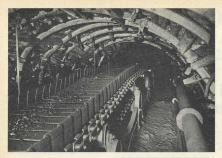
Fig. 1 - Trasportatore a scaglie articolate (Eickoff), per trasporto principale.
