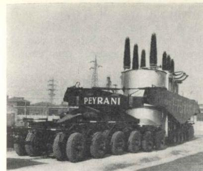
Fig. 4 - Rimorchio speciale da 220 t di portata utile in assetto di marcia.
