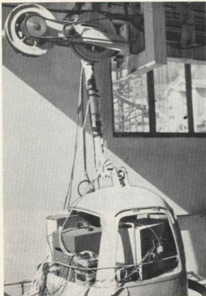
Fig. 14 - Particolare della sospensione in esame. Si possono notare i punti di applicazione degli estensimetri e degli accelerometri.
