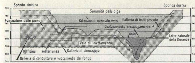
Fig. 5a - Sezione longitudinale della diga.
