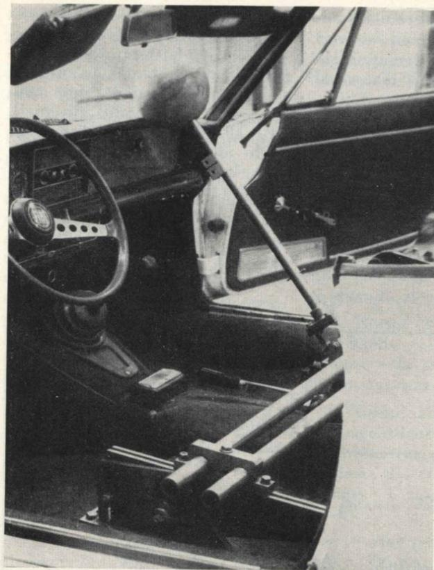
Fig. 1 - Dispositivo per determinare l'area di impatto del capo per un passeggero provvisto di cintura addominale.
