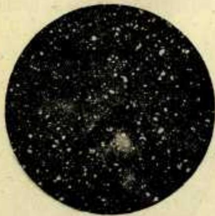
Fig. 10 - Grano del materiale raccolto dopo 2 ore di levigazione Ingrandito X 130
