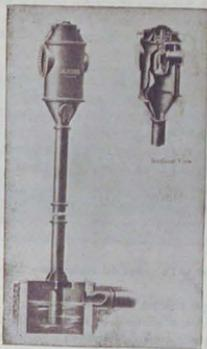
Fig. 93 — Il condensatore Alberger.
