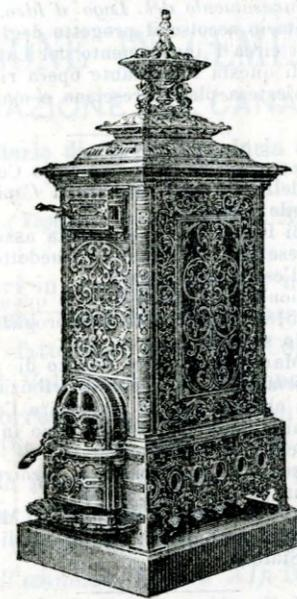
Fig. 6. — Stufa di ghisa (tipo inglese) con rivestimento del focolare in terra refrattaria. — Ornamentazioni esterne di ghisa pulita e nichellata, portine con lastre di mica.
