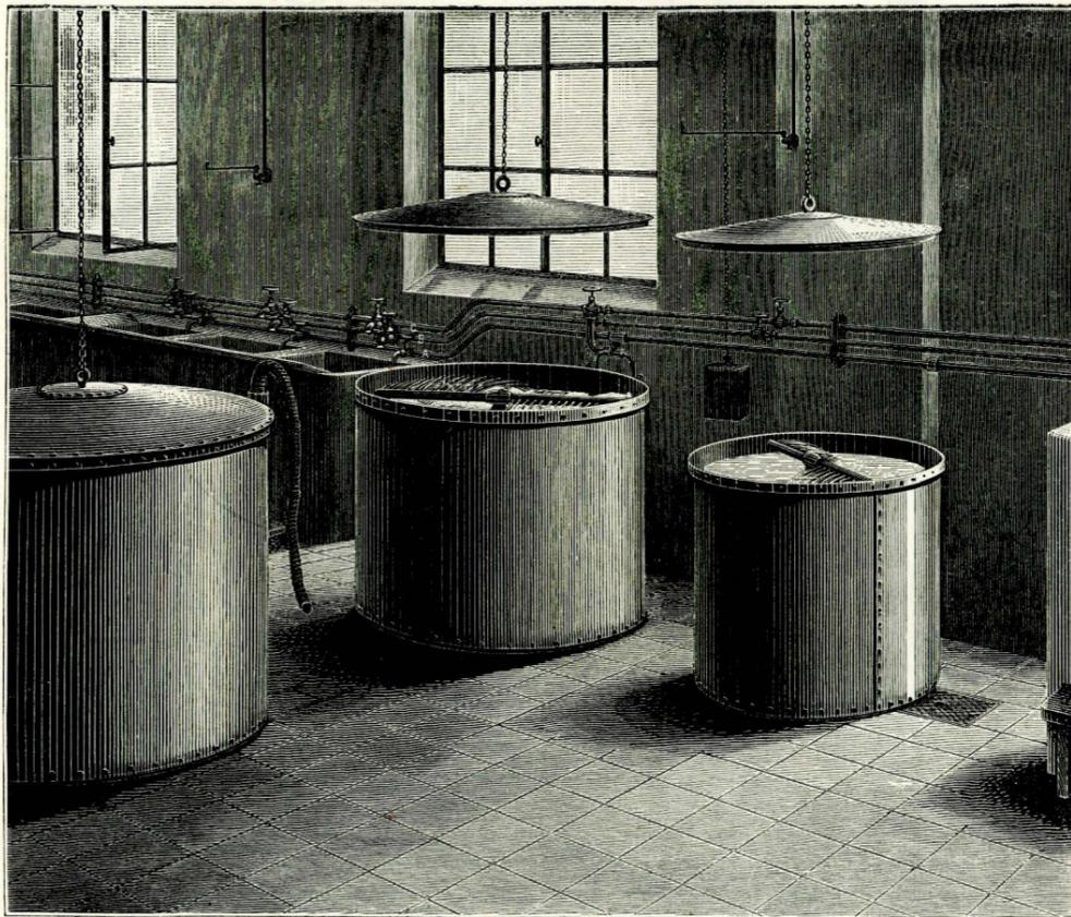
FIG. c. — Apparecchi per insaponare e lisciviare
