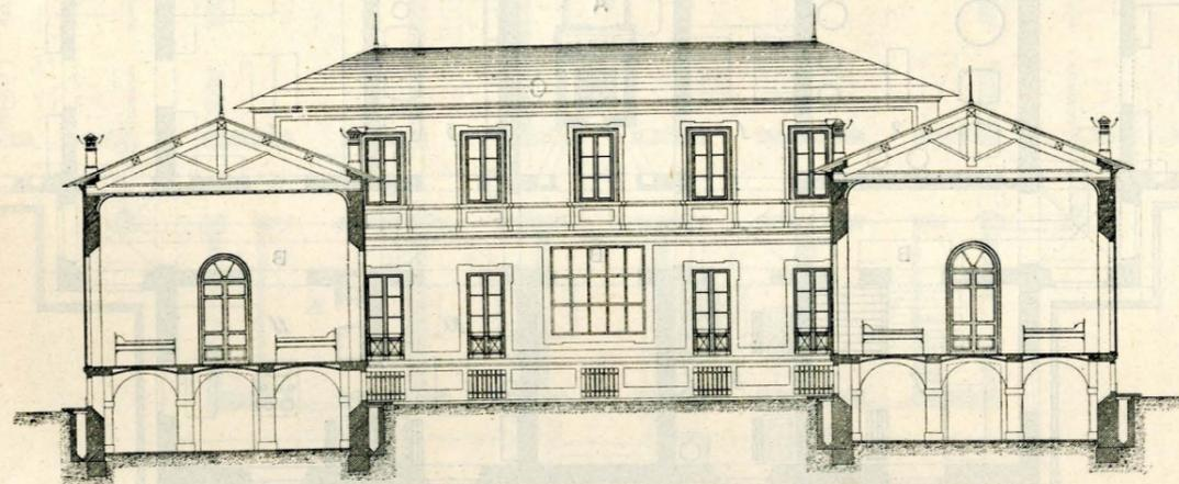
FIG. 2. — Prospetto interno del corpo centrale e sezione trasversale dei due padiglioni.
