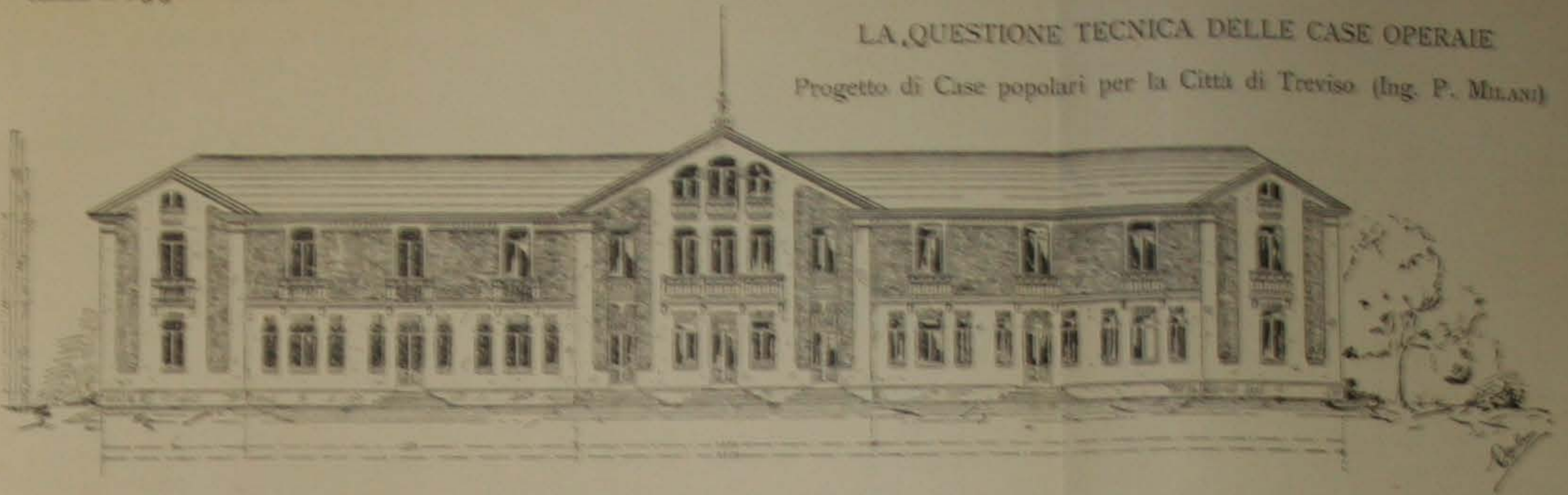
Prospetto geometrico della facciata verso via (Scala 1:200).
