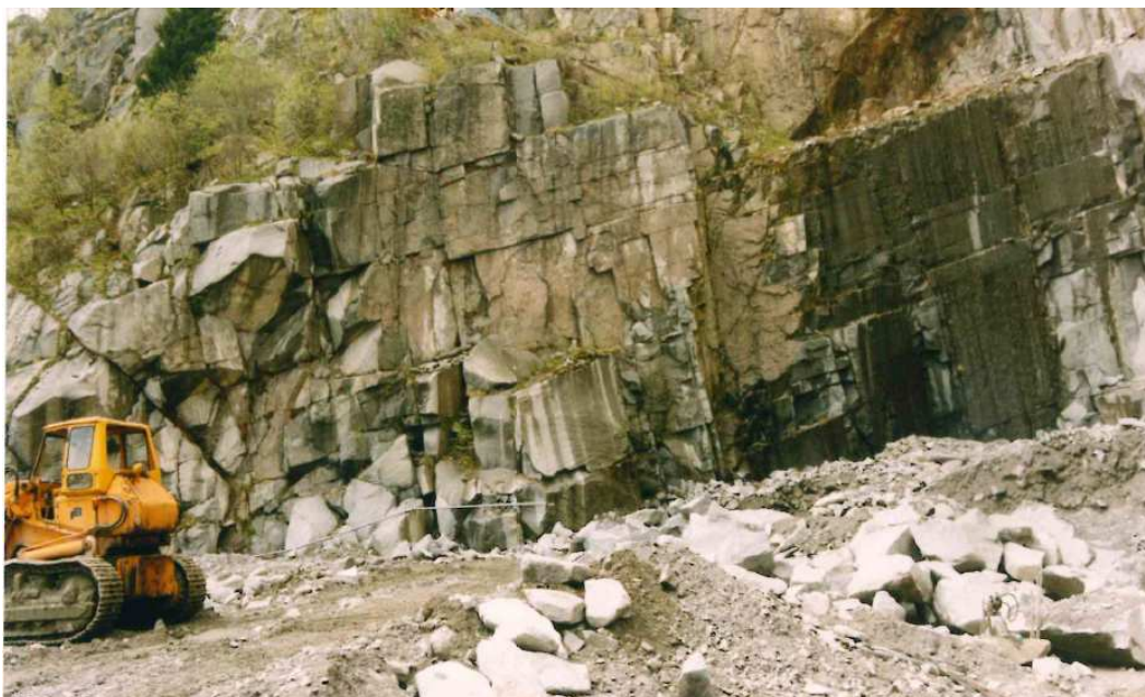
Fig. 2: Dettaglio del fronte in sinistra, con la parete rocciosa intensamente fratturata ed il cumulo detritico alla base
