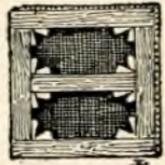
— (Dessin.) — Le châssis pour la mise au carreau se compose d'un carré de bois à jour, divisé en un certain nombre de carrés égaux, à l'aide de fils verticaux et de fils horizontaux. On place l'œuvre que l'on veut copier derrière ce châssis et l'on trace sur le papier un nombre égal de carreaux de dimension plus ou moins grande suivant que l'on veut augmenter ou diminuer la reproduction de l'original.
