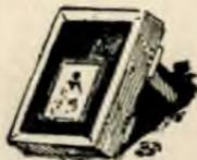
— **stéréoscopique.** — (Photogr.) — C'est un châssis permettant d'obtenir simultanément deux épreuves prises
