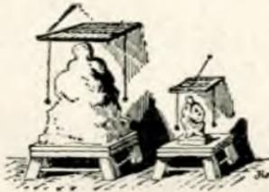
dont les côtés sont divisés et sur lesquels on fixe un fil à plomb. Ce fil à plomb peut se déplacer et détermine un parallépipède fictif à l'intérieur duquel se trouvent renfermés le bloc *épannelé* (voy. ce mot) et le modèle de la statue. On relève avec le compas la distance qui existe entre ce fil à plomb et un des points les plus saillants du modèle, puis on reporte cette distance sur le bloc. On
