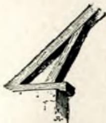
jambe de force est presque toujours posée obliquement. Dans les travaux de consolidation, elle est parfois maintenue à l'aide de cales
