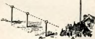
des jalons sont supportées par de petits blocs de bois bien dressés. Les jalons servent à fixer des points, à déterminer des lignes sur le terrain, pour aider au levé des plans, aux tracés, aux aligne-
