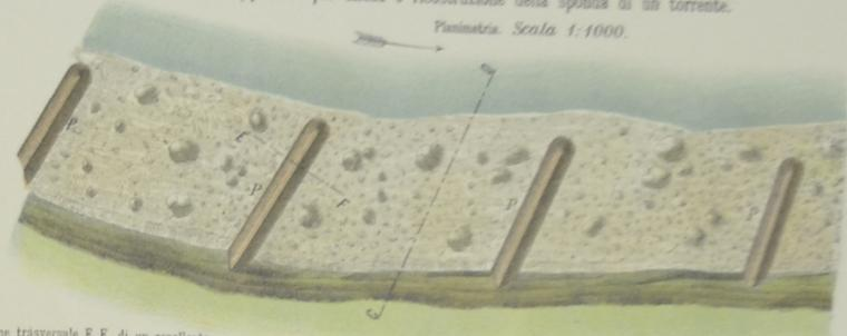
Serre o Briglie per evitare le erosioni e gli scoscendimenti, reggimare e consolidare l'alveo di torrenti montani.
