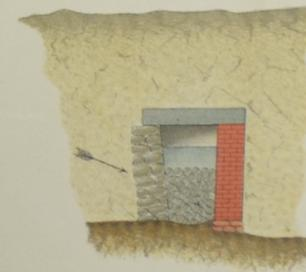
Collettore con un piedritto permeabile e volta in muratura.
