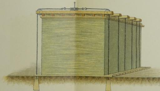
Particolari della vite di compressione e delle catene
