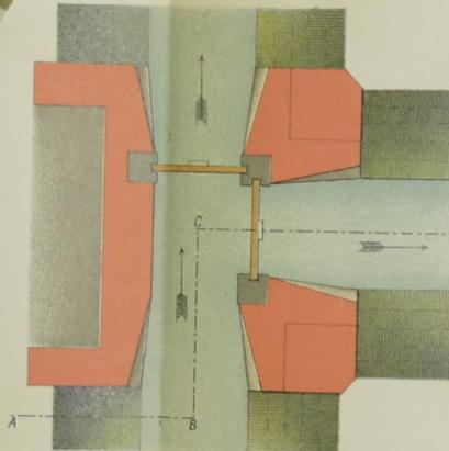
Sezione trasversale E F di un repellente
