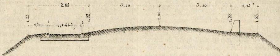
FIG. 8. — Strada e tramway Cuneo-Borgo S. Dalmazzo: profilo trasversale. Scala di 1 a 100.
