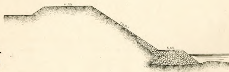
Fig. 3. — Sistemazione delle sponde con muraglioni nel tratto urbano — 1 : 500.
