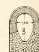
Fig. 9 e 10. — Sezioni dei collettori all'estremo — 1 : 200.
