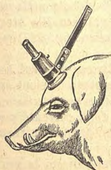
Fig. 223. — Apparecchio con chiodo a scanalatura per abbattere i suini.
