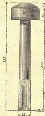
Fig. 218 a, b, c. — Sezione della placca e del bolzone della maschera Bruneau.
