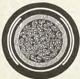
Fig. 298. — Cavo telefonico con isolamento in carta.
