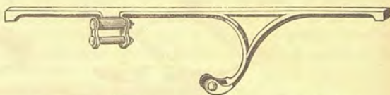
Fig. 2290. — Sopporlo per due molle, a collo di cigno, a doppio braccio, con orecchie e gemelli, e con un T saldato alla suola.
