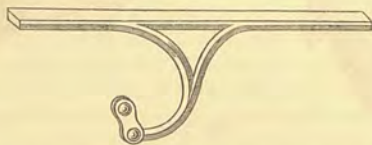
Fig. 2286. — Sopporlo a collo di cigno, a due braccia, con una suola sola e a gemelli.
