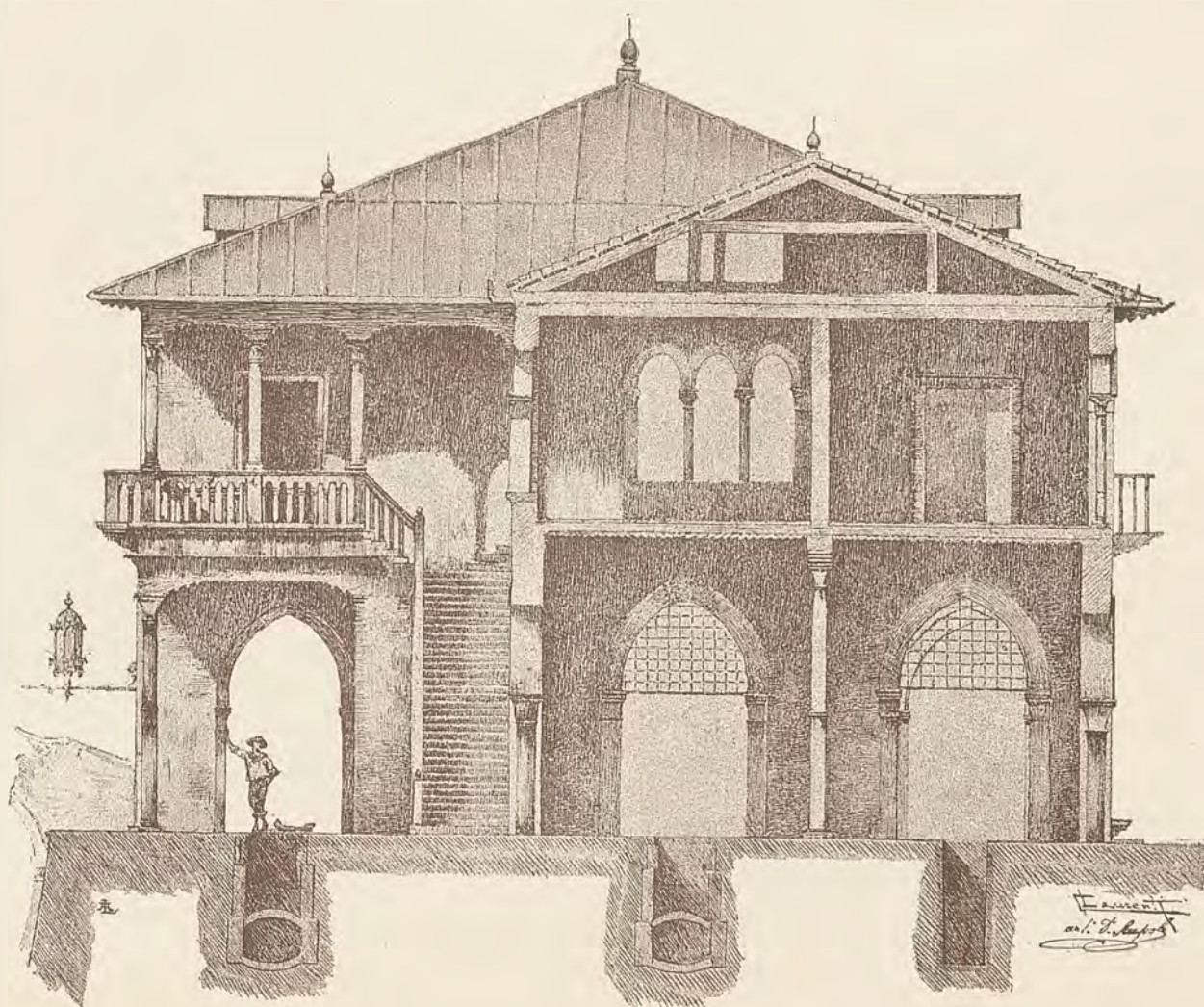
Sezione trasversale dello "STALON", restaurato e nuova testata del Mercato.
