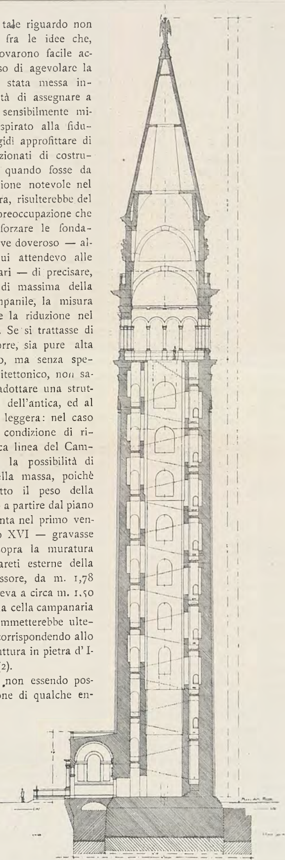
Studio di massima per la struttura interna (marzo-aprile 1903).
