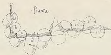
Schizzo dello zatterone e palificata — 1° aprile 1903.
