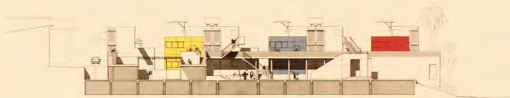
Quartiere sperimentale Franklin-La Brea, Los Angeles, 1989. Prospetto e sezione longitudinale. Varianti distributive degli alloggi con una e quattro camere.
