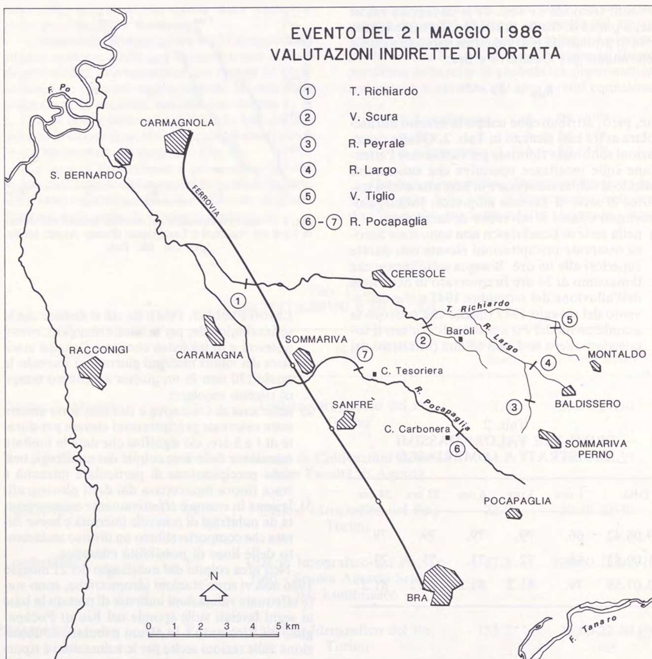
Fig. 5 - Ubicazione delle sezioni scelte per la valutazione indiretta della portata presumibilmente defluita nel corso dell'evento del 21 maggio 1986.
