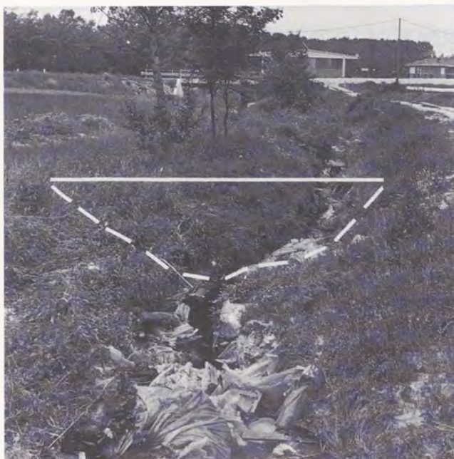
Fig. 6 - Rio Largo: tronco scelto per la valutazione indiretta di portata, visto da monte, con indicazione della sezione bagnata in base ai segni lasciati dalla piena.
