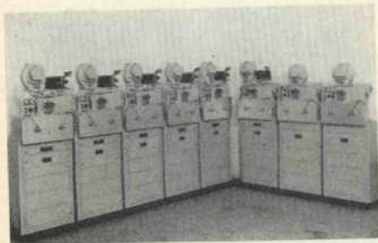
Fig. 11 - Bandspieler für Magnetton u. Lichtton-abstimmung.
