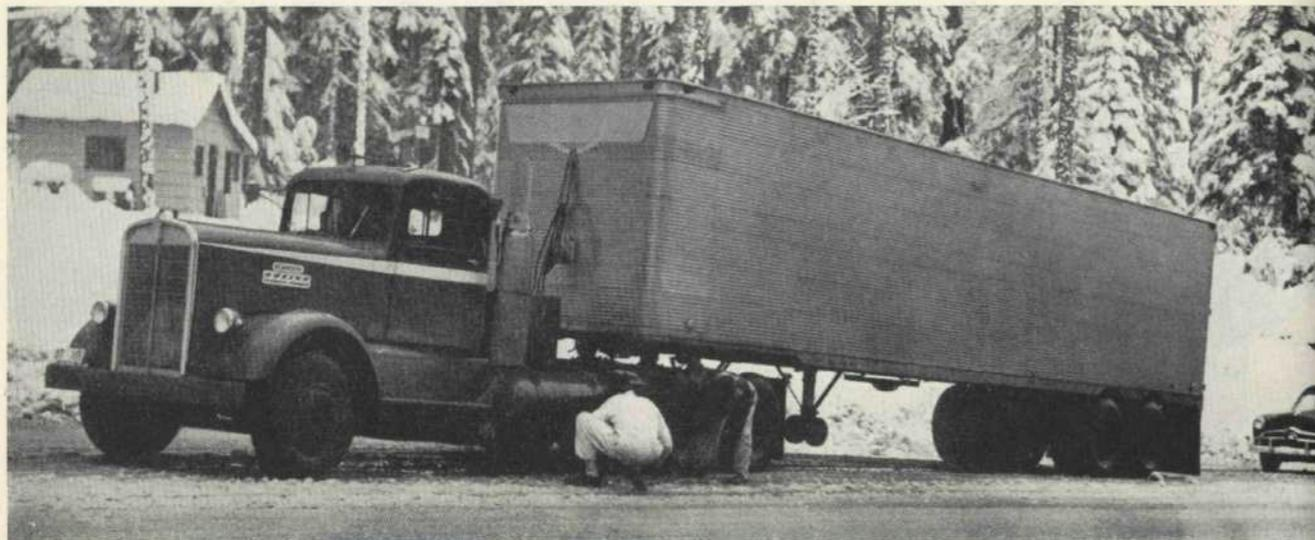
Fig. 20 - Autocarro Kenworth azionato da un turbomotore Boeing 502.
