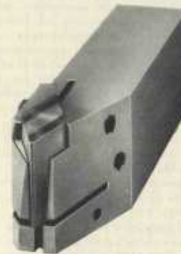
Fig. 7 - Nuovo tipo di utensile adatto per torni a copiare.
