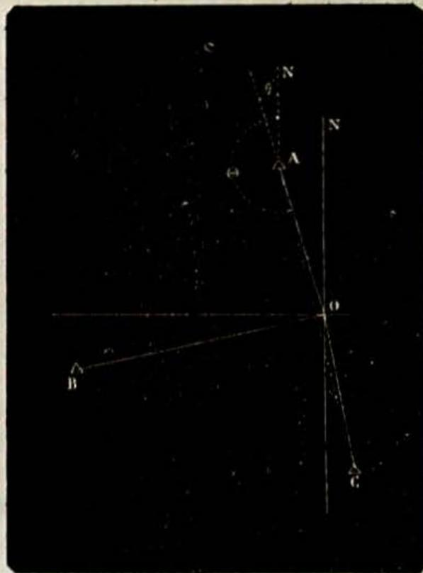
69. Soit la station O (fig. 17) voisine de l'alignement qui joint les deux points trigonométriques A C, on pourra dans ce cas arriver à la connaissance de l'orientation exacte de la station et de ses coordonnées par la méthode des approximations successives, et par le moyen des deux formules suivantes :
