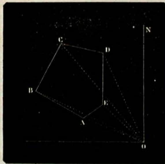
78. Soit un polygone (fig. 20) dont les sommets A, B, C, D, E, des angles relevés du point O ont donné les résultats enregistrés dans les cinq premières colonnes du tableau suivant ; dans lequel on trouve le point A écrit deux fois, pour plus de clarté, dans l'ordre des différences  $\Delta \theta$ .
