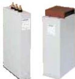
I condensatori trifase sono progettati per il rifasamento di impianti industriali in bassa tensione. La custodia esterna è in lamiera d'acciaio indeformabile nel tempo ed in grado di assicurare una buona dissipazione termica. Ogni unità capacitiva è realizzata in custodia metallica con incapsulamento dell'elemento avvolto in resina. Gli isolatori passanti ed il coperchio di protezione sono in materiale isolante non propagante la fiamma.
