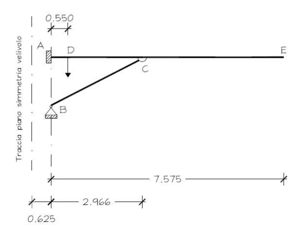
La figura precedente rappresenta lo schema strutturale semplificato della semiala di un velivolo (dimensioni in m), vincolata con incastro in A e con cerniera in B alla fusoliera. Il punto D rappresenta il baricentro di un serbatoio alare. Il controvento BC è incernierato in C alla semiala.
