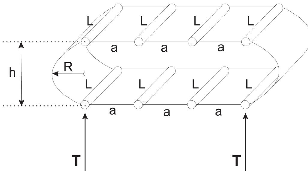
Il cassone alare proposto in figura è composto da 8 correnti (area  $A$  uguale per ciascuna sezione) e 8 pannelli, e ha dimensioni:  $L=350$  mm (lunghezza ciascun corrente),  $a=200$  mm (distanza fra correnti lungo un lato del pannello),  $h=250$  mm (altezza del cassone) e  $R=125$  mm (raggio dei pannelli curvi). Ciascuna forza  $T$  è pari a 1000 N.
