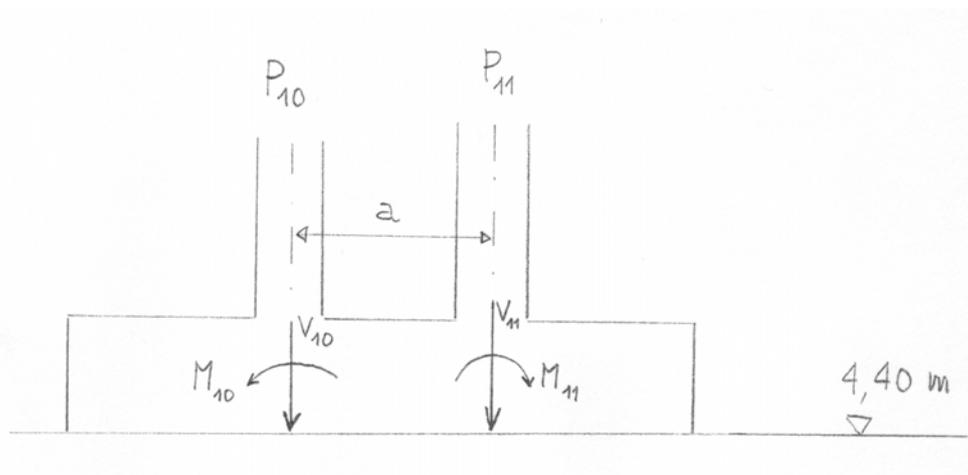
I pilastri sono a sezione quadrata ( $40 \times 40 \text{ cm}^2$ ) e i carichi caratteristici da impiegare per il dimensionamento della fondazione (riferiti agli assi baricentrici dei due pilastri) risultano pari a:
