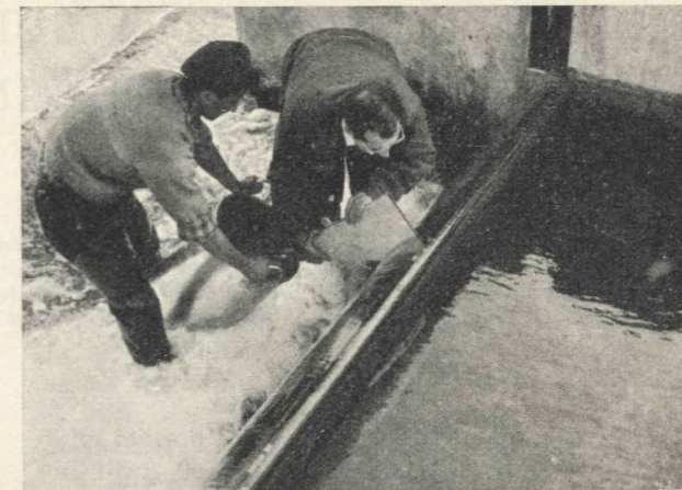
Fig. 9 - Misura delle infiltrazioni nel canale di scarico della Centrale di Demonte.
