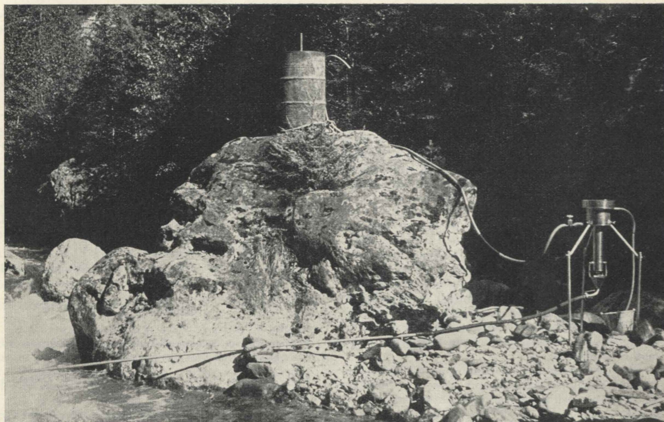
Fig. 1 - Misure di portata con il metodo chimico al bicromato di soda (installazione di campagna).
