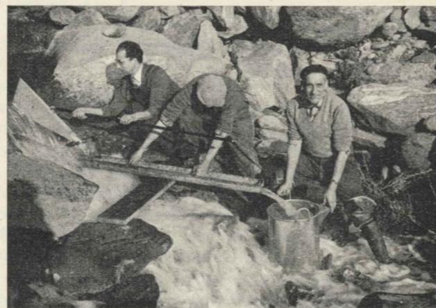
Fig. 4 - Taratura del prelevatore a fessura sullo stramazzo Bazin allo scarico della Centrale di Olivioni.
