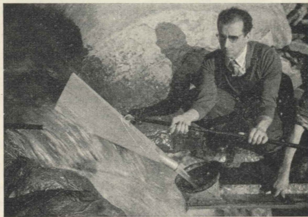
Figg. 6 e 7 - Misura della portata di un torrentello per mezzo del prelevatore a fessura.
