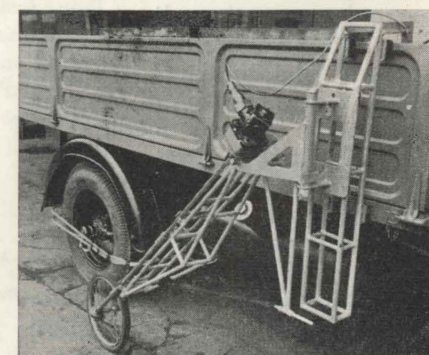
Fig. 3 - Applicazione ruota Peiseler su autocarro OM 20.102 « Lupetto ».
