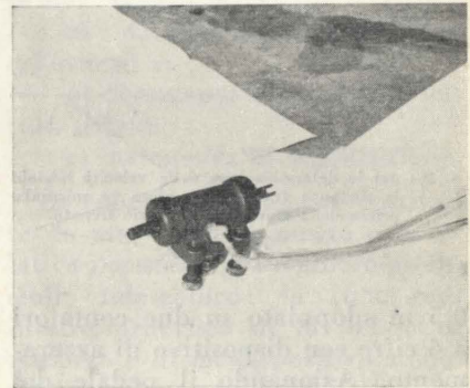
Fig. 8 - Applicazione termocoppia al cilindro comando freni.
