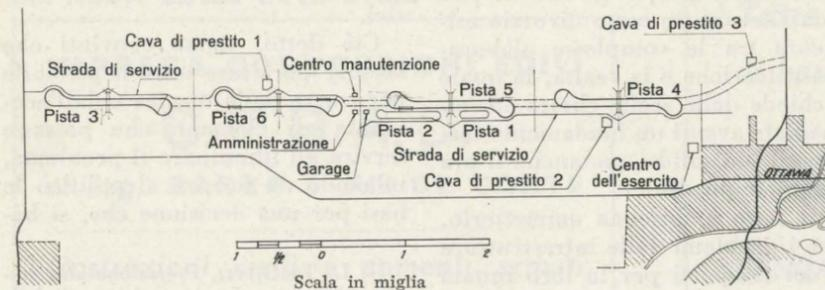
Fig. 1 - Pianta della zona della prova stradale AASHO. Ciascuno dei tratti rettilinei delle piste di prova è costituito da una successione di sezioni di pavimentazione di diverso spessore e di diverso tipo (rigide o flessibili). Ogni pista è stata sottoposta a 1.100.000 applicazioni di carico. Il peso asse massimo in circolazione è stato di 13,6 t. (21,8 t. per l'asse doppio).
